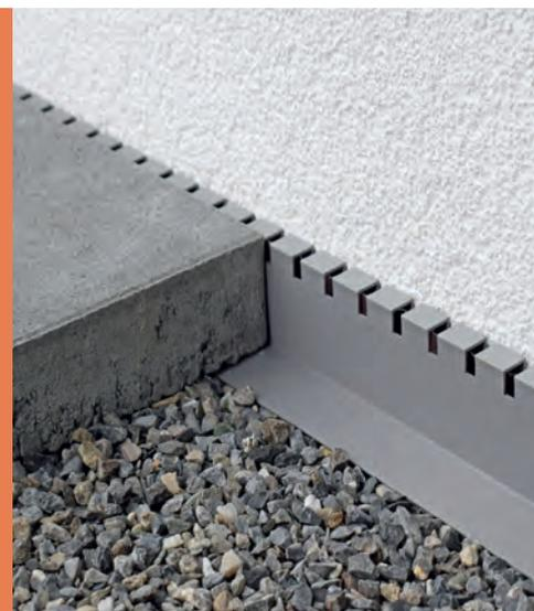
Das **disto® Distanzprofil** ermöglicht eine saubere und unauffällige Distanz zwischen den Gartenplatten und der Außenwand. Dank der Lasche, die unter die Platte reicht, bleibt das **disto® Distanzprofil** in Position und wandert nicht mit der Zeit aus der Fuge heraus. Gesicherter Feuchtigkeitstransfer entlang der Fassade.
