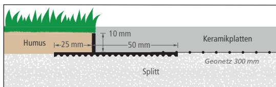
steinfix® netz10 für Keramikplatten
