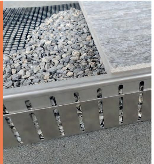
Das variafix® erlaubt die Befestigung des Belags inklusive dem Splittbett. Das Element ist in der Höhe verstellbar und kann so auch im Gefälle eingesetzt werden. Dank dem montierten Geogitter wird das variafix® durch das Eigengewicht des Belags dauerhaft und ohne Nägel fixiert. variafix® besteht aus einem Basiswinkel und einem angeschraubten und höhenverstellbaren Aufsetzelement. Das Element ist in zwei Höhen verfügbar.
